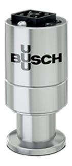
Аналоговые датчики GRP 100/200 представляют собой пьезорезистивные вакуумметры, идеально подходящие для измерения давления от 1400 до 1 mbar. Благодаря прочному датчику из алюмооксидной керамики они практически не подвергаются загрязнению и поэтому идеально подходят для сложных задач.
