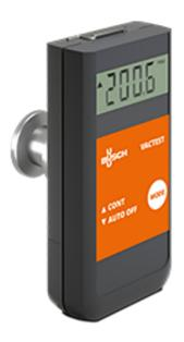
Мобильный измеритель TRP 900 является идеальным портативным решением для измерения давления независимо от типа газа в диапазоне от 1600 до 1 mbar. Этот пьезорезистивный вакуумметр, разработанный для облегчения технического обслуживания вакуумных установок, можно использовать также в системах вакуумной упаковки или для обеспечения качества вакуумного процесса.
