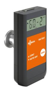
Мобильный измеритель TPP 900 представляет собой портативное решение с батарейным питанием, в котором пьезорезистивный датчик сочетается с прочной спиральной нитью Пирани. Этот вакуумметр обеспечивает точное измерение давления в широком диапазоне — от 1200 до 1·10-4 mbar.
