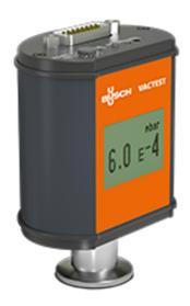
Цифровой датчик DTP 400 С — это коррозионностойкий вакуумметр Пирани, основанный на архитектуре микроконтроллеров последнего поколения. Прочная и надежная спиральная нить обеспечивает широкий диапазон измерения давления — от атмосферного до 5⋅10-⁴ mbar.
