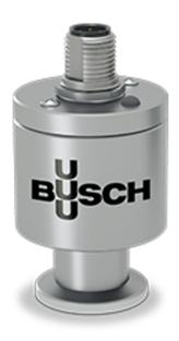
Аналоговый датчик GCD 200 представляет собой емкостный вакуумметр, специально разработанный для дегазации стали и других сфер применения, требующих точного измерения давления в диапазоне от 200 до 0,1 mbar. Это очень прочный датчик из алюмооксидной керамики, сочетающий в себе высокую надежность и устойчивость к загрязнению.
