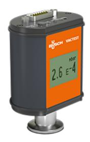
Цифровой датчик DPP 400 относится к новейшему поколению вакуумметров на основе микроконтроллера, сочетающих в себе пьезорезистивный датчик и прочную спиральную нить Пирани для обеспечения точного измерения давления в полном диапазоне — от 1200 до 1⋅10-⁴ mbar.
