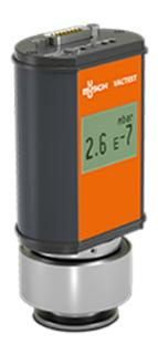
Цифровой датчик DCC 400 — это надежный ионизационный измеритель с холодным катодом, основанный на архитектуре микроконтроллеров последнего поколения. Этот датчик оснащен обращенным датчиком магнетронного типа, идеально подходящим для измерения давления в диапазоне от  $2 \cdot 10^{-3}$  mbar до  $5 \cdot 10^{-9}$  mbar.
