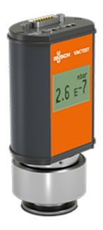
Цифровой датчик DPC 400 относится к новейшему поколению вакуумметров на основе микроконтроллера, сочетающих в себе датчик ионизации с холодным катодом и прочную спиральную нить Пирани для обеспечения полного диапазона измерения давления, от атмосферного до 5 · 10<sup>-9</sup> mbar.
