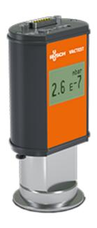
Цифровой датчик DPH 400 относится к новейшему поколению вакуумметров на основе микроконтроллера, сочетающих в себе ионизационный датчик с системой Байярда-Альперта и прочную спиральную нить Пирани для обеспечения полного диапазона измерения давления, от атмосферного до 5⋅10-10 mbar.
